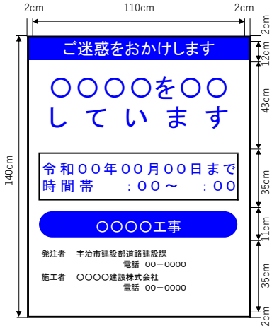
(標示板の記載例) [工事表示板]
